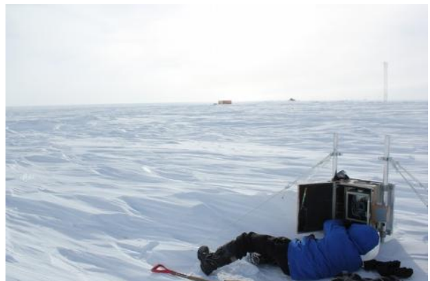
写真3 みずほ基地無人磁力計 データカード交換の様子
