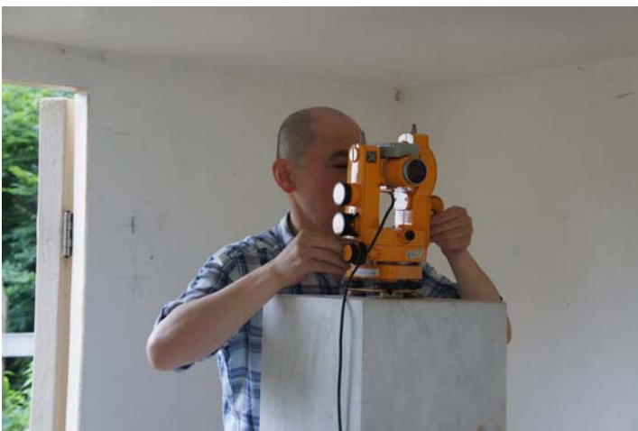
写真1(上) チョンヤン地磁気観測所での絶対観測
