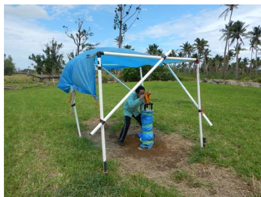
写真2 磁気儀を用いた地磁気絶対観測
