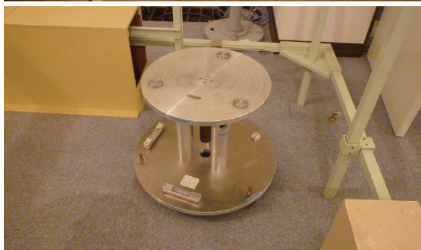
図2 中心部にHFMセンサーをセットした大型3軸コイル（左上），HFMセンサーとアルミ製センサー搭載台（右上），アルミ製センサー搭載台（左下），塩ビ製センサー搭載台（右下）
