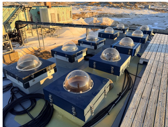
写真6：オーロラカメラ 異なる波長を撮影するためにいくつもの 全天カメラを設置している
