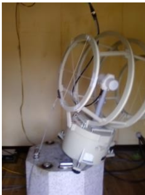
写真1 震災直後のオーバーハウザー磁力計 (現在は復旧済み)
