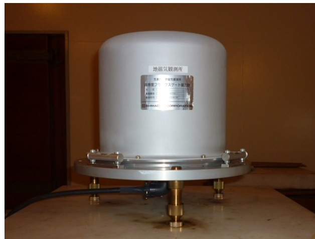
写真1 フラックスゲート磁力計センサー
