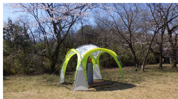
写真2：比較観測用器械台に磁気儀および天幕をセットした状態
