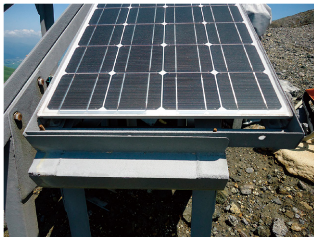
写真4 火山ガスによる太陽電池モジュールの腐食
