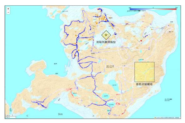
図 2 徒歩での全磁力磁気測量結果 (東オングル島全体)
