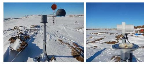
図 9 オーバーハウザー磁力計のアルミ製センサポールと塩化ビニール製センサカバー (左)、センサカバーを取り外した状態(右)
