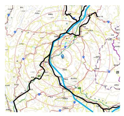
図3 松代地震観測所と鉄道の位置(地理院地図に加筆) 黒線が直流電化 1500V、青線が交流電化 25000V、 松代地震観測所から半径 5km ごとに円を描いた。
