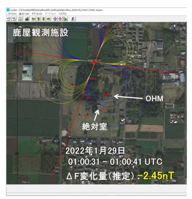
図 9 鹿屋の絶対観測で地点差測定中に発生した人工擾乱の再現事例 (2022 年 1 月 29 日)。
