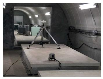
写真1 松代地震観測所大坑道地震計室に設置した フラックスゲート磁力計(手前)とオーバーハウザー磁力計(奥)
