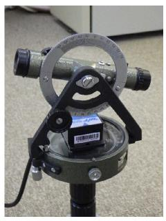
図1:小型磁気センサーを用いた偏角伏角計の試作機
